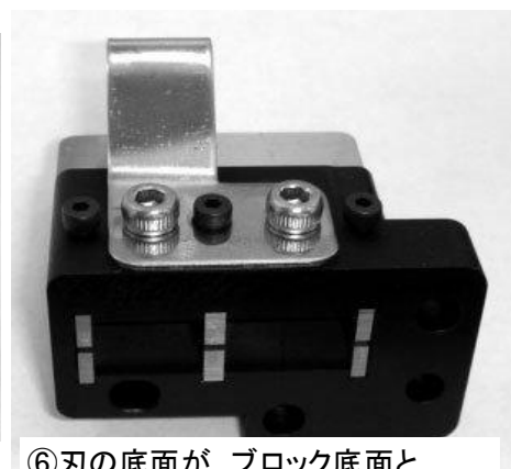
⑥刃の底面がブロック底面と段差が無いように取り付けます ネジ F で固定します
