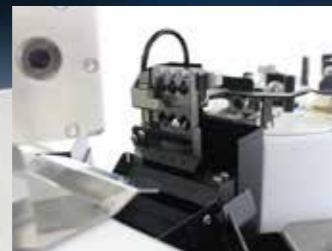
切断・先端剥き・後端剥きの刃を区別化
